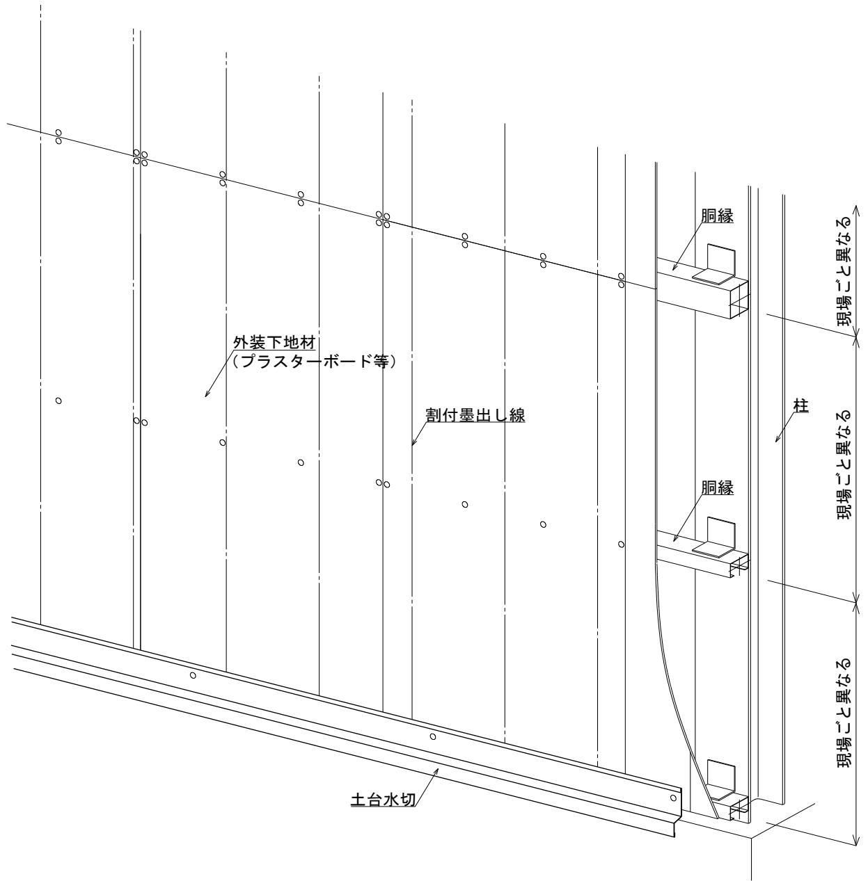
● 最下部の脣縁へ土台水切をビス留めし取付けて下さい。
