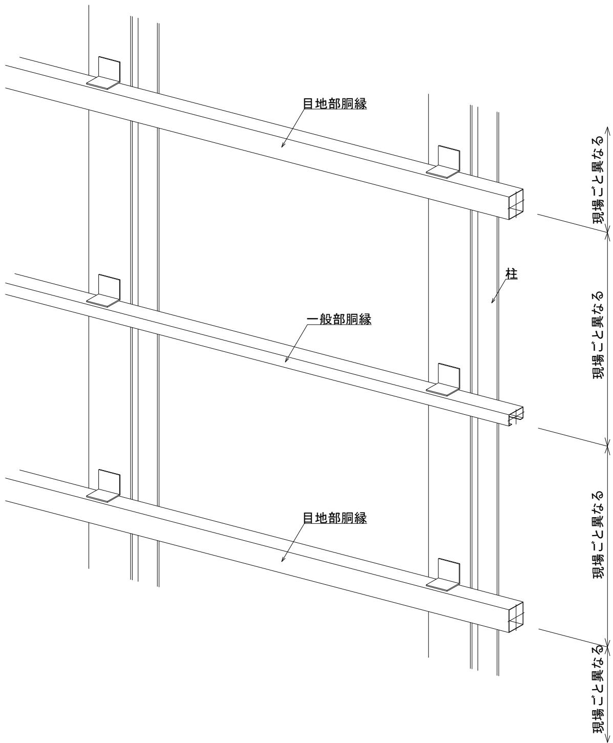
● 外装下地材（主に継ぎ目部分）が取付けられる間隔で胴縁が取付けられているか確認して下さい。
