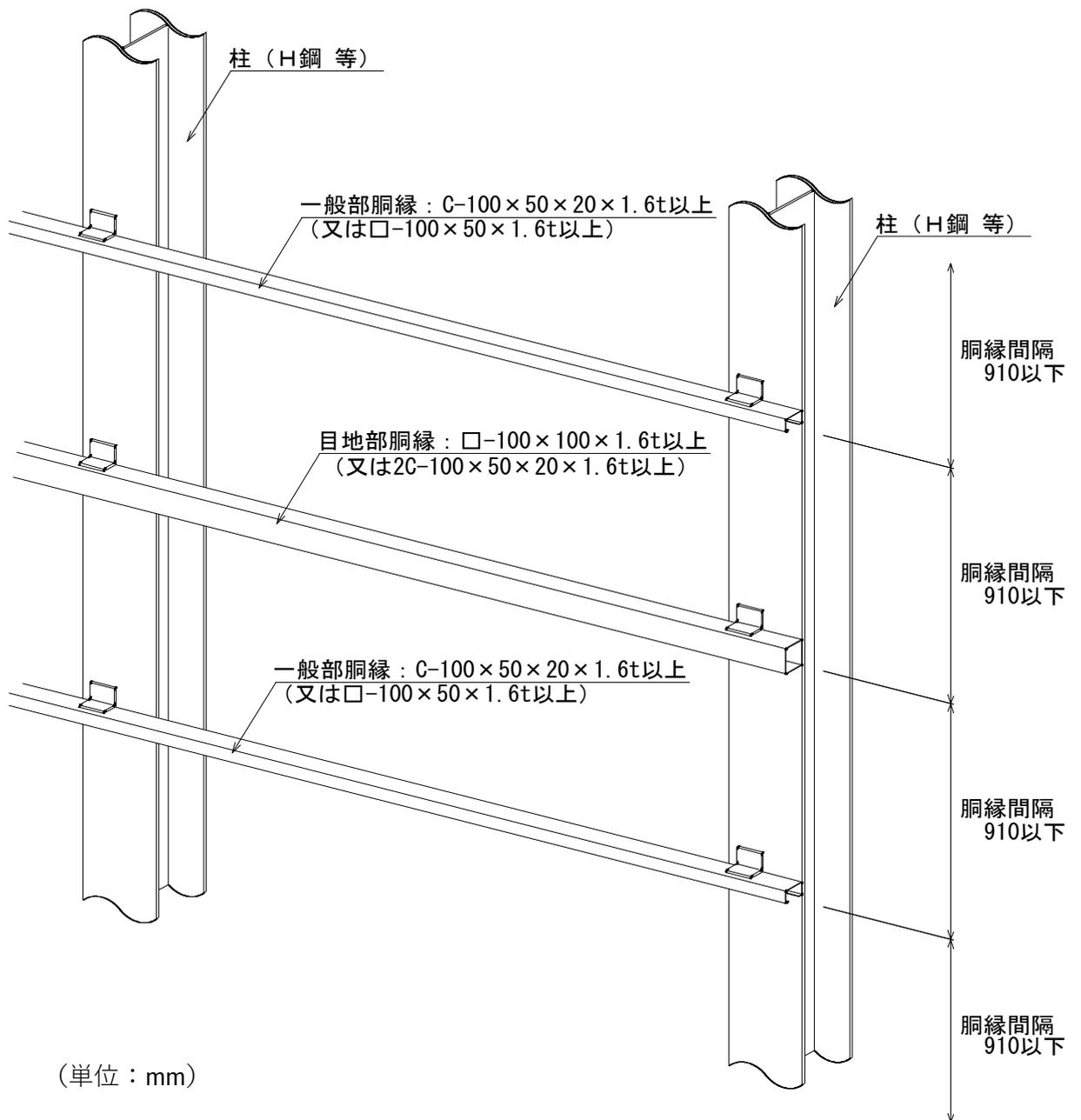
● 下地に以下の材料を使用し、胴縁間隔は910mm以下となっていることを確認して下さい。
