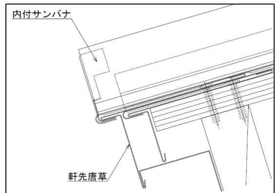
● 内付サンバナを葺き板の切欠き部と軒先唐草の間に差し込み、葺き板のつかみ代を軒先唐草につかみ込みます。
