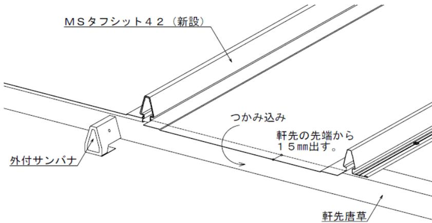
● 葺き板の切欠き部を軒先唐草につかみ込み、葺き板本体の先端嵌合部の外側にはめ込んでアルミリベット (φ3.2) 等で止めます。
